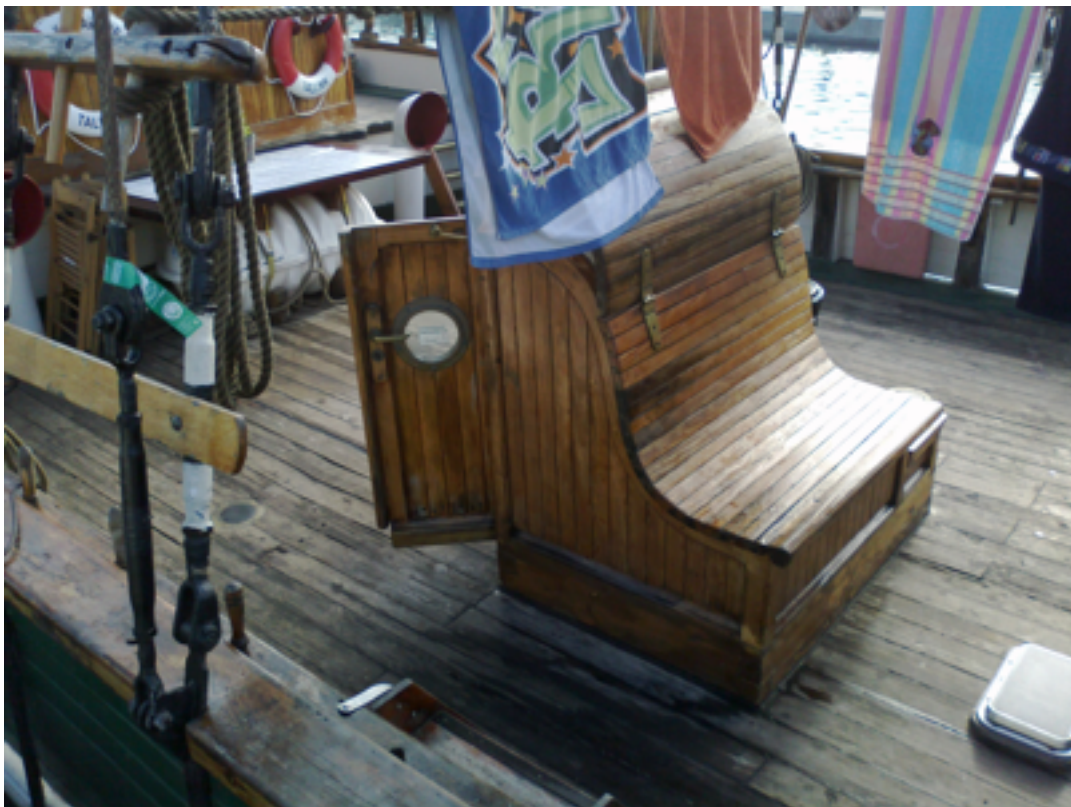
Trappbrunnstak, foto ©Aaro Söderlund 2012
